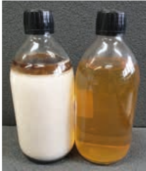
links: Medium mit freien Ölen, emulgiertem Öl und Partikeln; rechts: Filtrat mit Reinigungschemie, diese bleibt erhalten und kann sofort wiederverwendet werden
