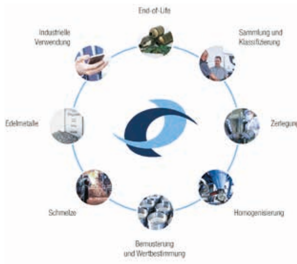
Die Stufen des Recyclings von Edelmetallen am Ende der Nutzungsdauer
