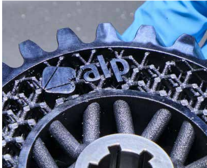
Hybride additive Fertigung: Zahnrad in Leichtbauweise und hoher Oberflächengüte
