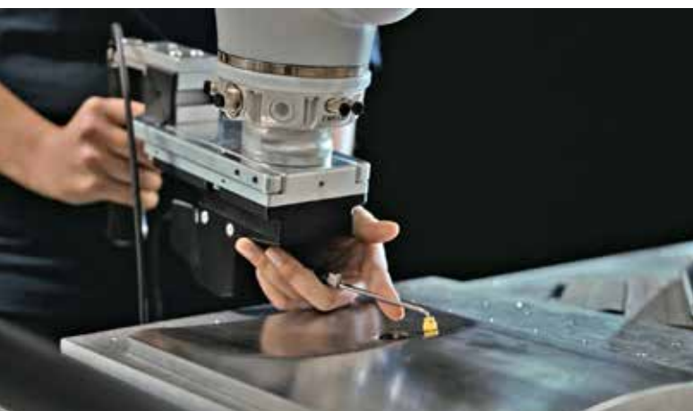
Manueller Teachingvorgang und selbständige Durchführung des Prozesses durch den Roboter
