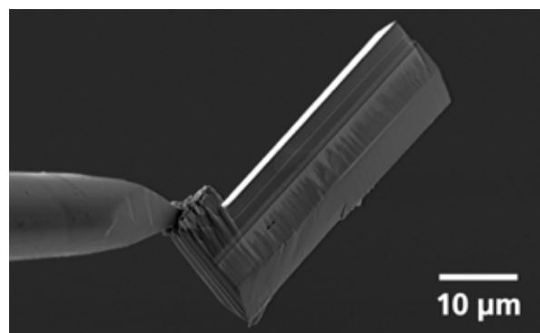
Abbildung 2: Ein mit Hilfe des Ionenstrahls im Rasterelektronenmikroskop erzeugter Materialstreifen aus einer LED, angeschweißt an einem Mikromanipulator. Derartige Lamellen dienen als Ausgangspunkt sowohl für die Transmissionselektronenmikroskopie als auch für die 3D-Atomsondenmikroskopie.
