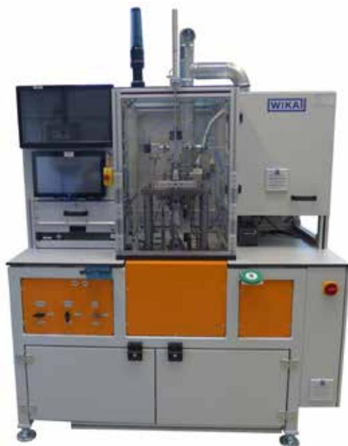
Helium-Dichtheitsprüfanlagen für Drucksensoren
