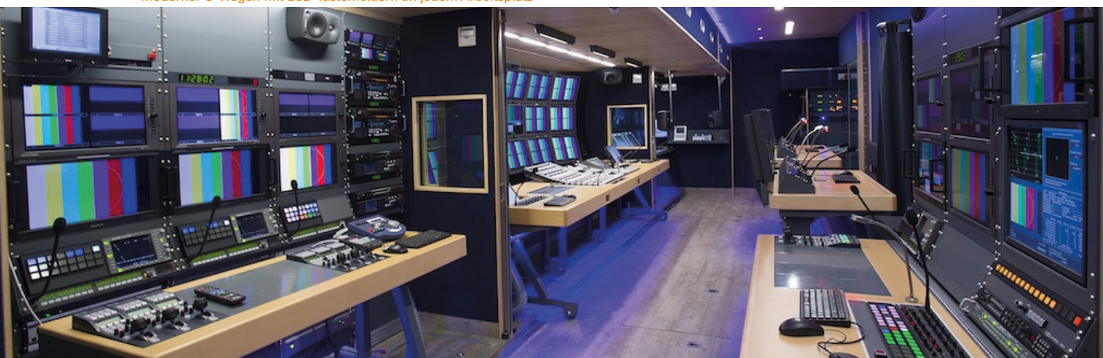
Moderner Ü-Wagen mit LCD-Tastenfeldern an jedem Arbeitsplatz
