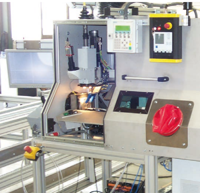
Bild 1: Laserschweißautomat Tür geöffnet
