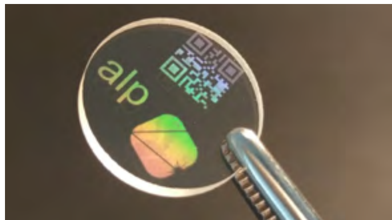
Laserbeschriftung von Quarzglas
